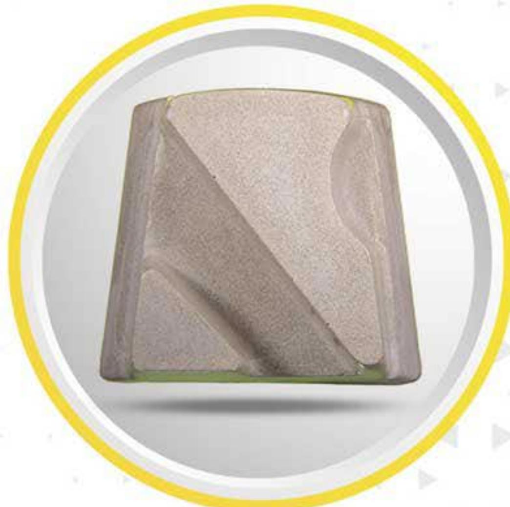
از باند منیزیتی به همراه سلیکون کارباید ساخته می شود. ابزاری جهت استفاده در ماشینهای ساب ( اتوماتیک و نیمه اتوماتیک ) برای ساب و صیقلی کردن سنگهای ماربل ( تراورتن، مرمریت، مرمر ) و سنگهای مصنوعی استفاده می شود که این محصول در دو تیپ توپر و توحالی تولید می شود.
