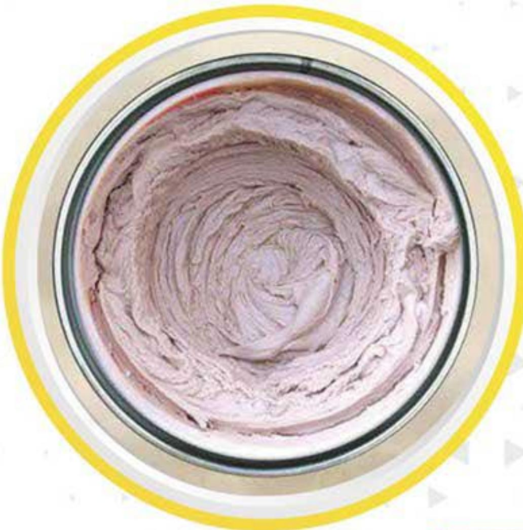
محصولی تولید شده از رزین های پلی استر به همراه فیلرهای پودری و چند نوع ادتبو که خواص مختلف از جمله پایداری و حالات و شکل دهی ماستیک را کنترل می نماید و برای پر کردن سوراخ های سنگ های تراورتن و مرمریت استفاده می گردد که با هاردنر بنزوئیل پراکساید سخت می شود این ماستیک با امکان تولید در 18 رنگ مناسب با سنگ های موجود در بازار تهیه و با کدهای مخصوص به بازار عرضه می گردد.
