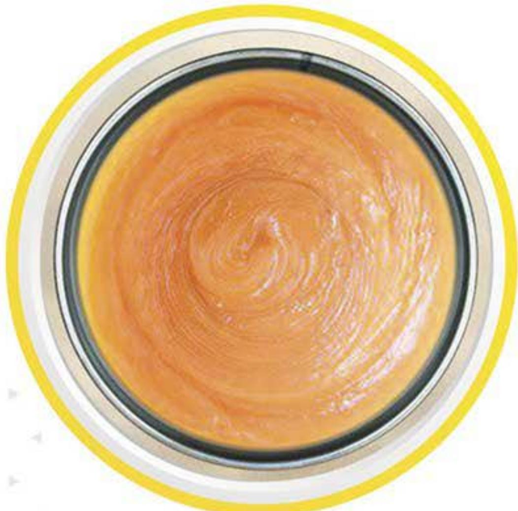
محصولی تولید شده از رزین های پلی استر به همراه فیلرهاي پودري و چند نوع ادتيو که خواص مختلف از جمله پايداري و حالات و شكل دهي ماستيک را كنترل مي نمайд و برای پر کردن سوراخ های سنگ های تراورتن و مرمریت استفاده مي گردد که با هاردنر بنزوئیل پراکساید سخت مي شود.
